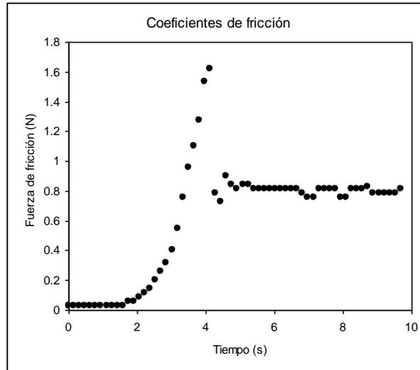
Figura 6.3. La fuerza de fricción. Gráfica construida con los valores experimentales reportados en la referencia 1.
