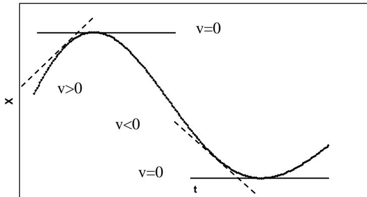
Figura 2.12. El signo de la velocidad en un punto de la curva es el mismo que el de la pendiente de la recta tangente a la curva en ese punto.
