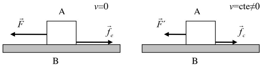
Figura 6.4. Cuando los cuerpos en contacto no están en movimiento, uno respecto al otro, la fuerza de fricción estática actúa, pero si hay movimiento relativo lo hace la fuerza de fricción cinética.
