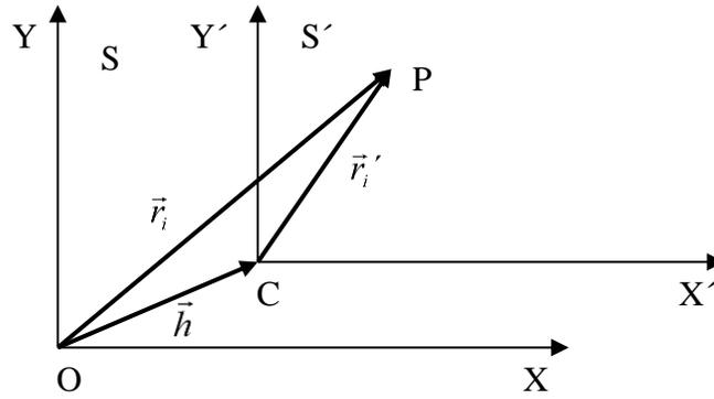
Figura 12.2. El origen del sistema S está en el punto arbitrario O mientras que el sistema S' es paralelo al sistema S y su origen está en el centro de masa C.
