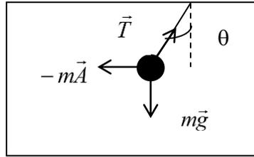
Debido a que la tangente del ángulo es proporcional a la aceleración, si se mide el ángulo entonces una plomada colgada del techo de un vehículo puede usarse como un acelerómetro.
