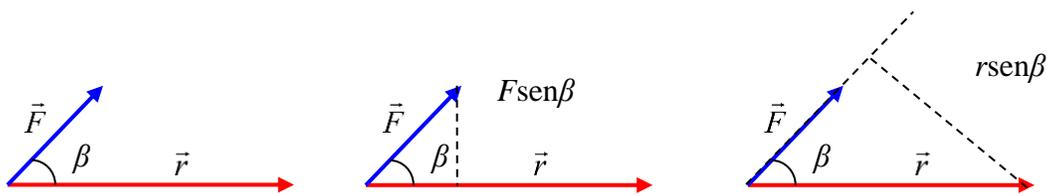
Figura 12.5b. Los vectores  $\vec{r}$  y  $\vec{F}$  están dibujados a partir de un punto común.
