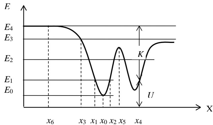
Figura 8.8. Curva de una función potencial arbitraria que exhibe un máximo y dos mínimos.
