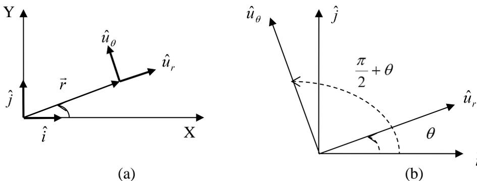
Figura 11.2. (a)  $\hat{u}_r$  apunta en la dirección en que  $\vec{r}$  crece,  $\hat{u}_\theta$  apunta en la dirección en que  $\theta$  crece. (b) El origen de los vectores  $\hat{u}_r$  y  $\hat{u}_\theta$  se hace coincidir con el origen de los vectores  $\hat{i}$ ,  $\hat{j}$ .
