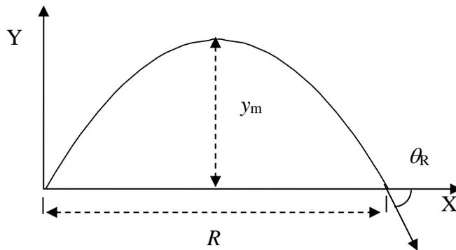
Figura 4.5. La trayectoria del proyectil es una parábola si se supone que el aire no presenta resistencia alguna.
