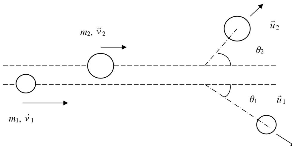
Figura 10.6. Las velocidades antes de la colisión son  $\vec{v}_1$  y  $\vec{v}_2$ , después de la colisión son  $\vec{u}_1$  y  $\vec{u}_2$ .
