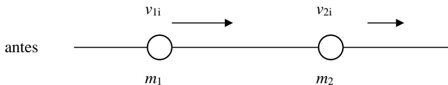
Figura 10.1. Si  $v_{1i} > v_{2i}$ , la partícula 1 choca con la partícula 2.
