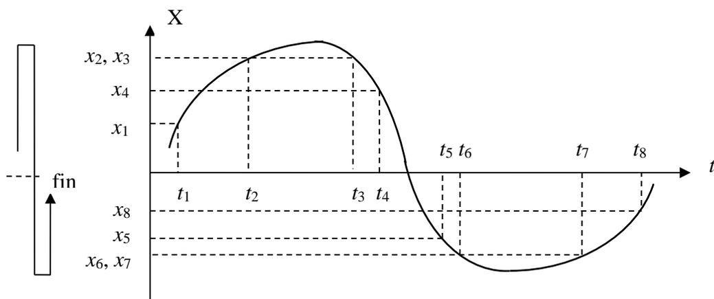
Figura 2.8. Se muestran diferentes posiciones que originan desplazamientos positivos, negativos y nulos.
