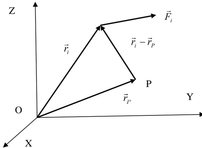
Figura 13.8. La fuerza  $\vec{F}_i$  se aplica en la posición  $\vec{r}_i$  respecto al origen O y en la posición  $\vec{r}_i - \vec{r}_p$  respecto al punto P.
