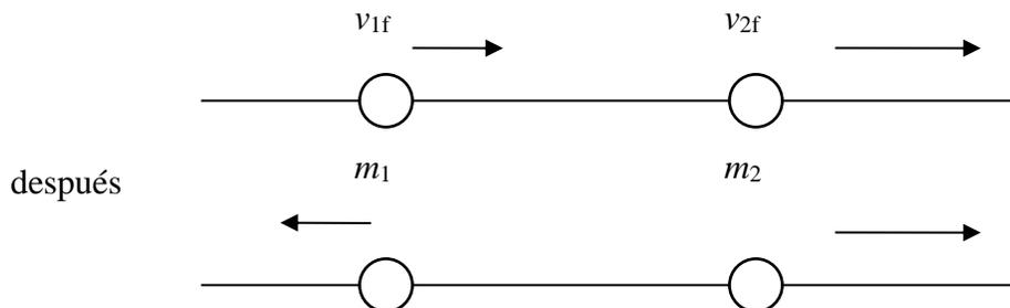
Figura 10.5b. Se muestran dos posibles movimientos de la partícula proyectil.
