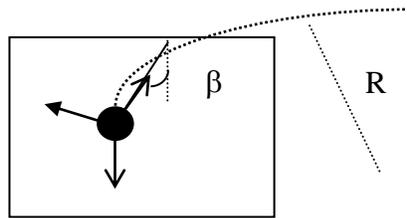
Figura 11.9. Esta fuerza inercial que aparece en el sistema acelerado es llamada fuerza centrífuga.
