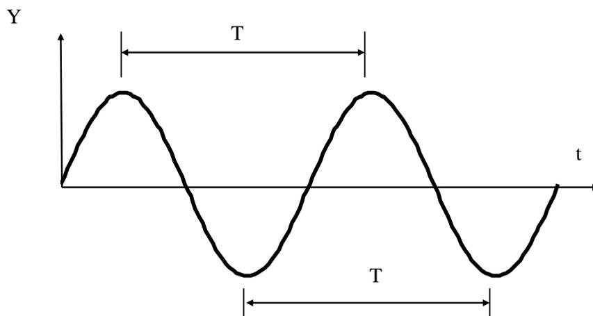
Figura 15.4. Desplazamiento en función del tiempo. El periodo  $T$  de la oscilación de la cuerda es el tiempo en que la onda pasa dos veces consecutivas por un mismo punto cualquiera de la cuerda.
