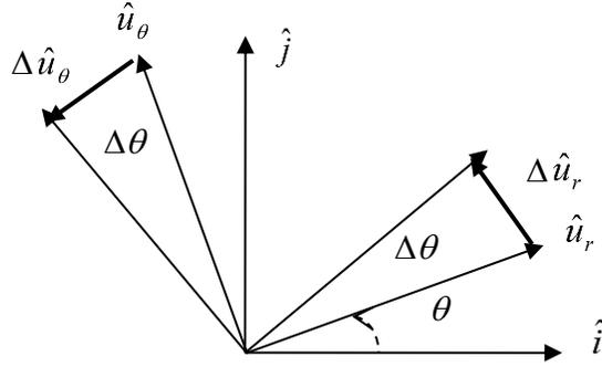
Figura 11.3. Al cambiar el ángulo de la figura 11.2(b) de  $\theta$  a  $\theta + \Delta \theta$ , el cambio en los vectores unitarios  $\hat{u}_r$  y  $\hat{u}_\theta$  es  $\Delta \hat{u}_r$  y  $\Delta \hat{u}_\theta$ .
