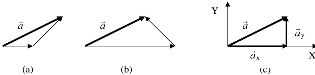
Figura 3.7. Cualquier vector puede representarse como la suma de dos vectores mutuamente perpendiculares.
