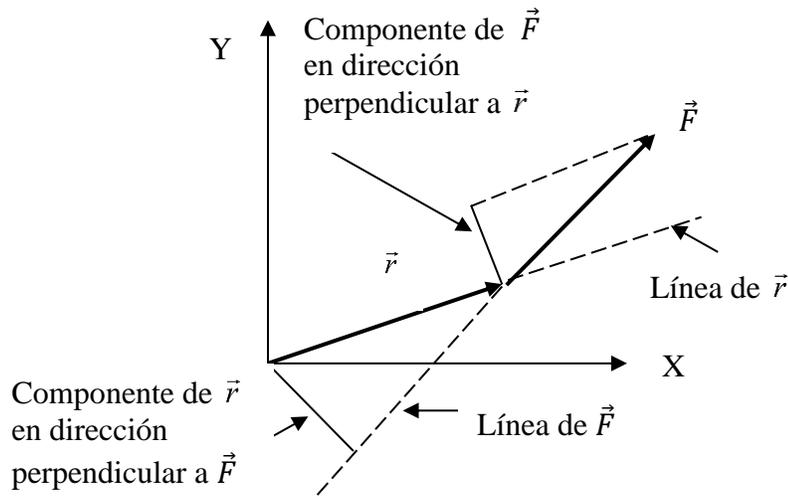
Figura 12.5a. Interpretación geométrica de la magnitud del producto vectorial entre  $\vec{r}$  y  $\vec{F}$ .
