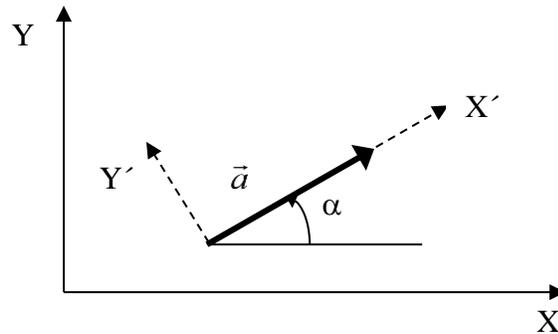
Figura 3.4. Un vector representado en dos sistemas de referencia distintos.
