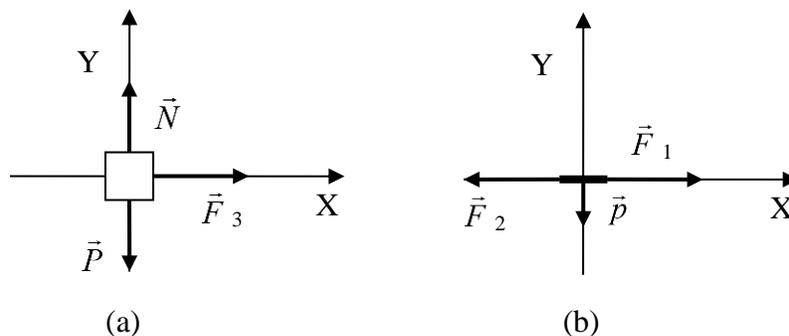
Figura 5.7. Fuerzas que actúan sobre (a) el bloque y (b) sobre la cuerda.
