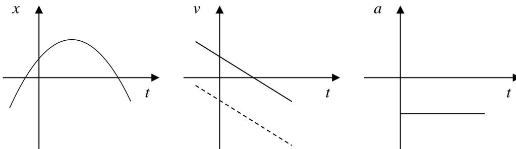
Figura 2.15b. Las ramas de la parábola se abren hacia abajo cuando  $d$  es negativa.
