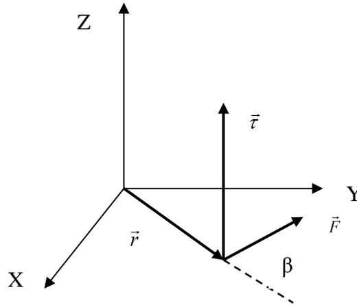
Figura 12.4. Si los vectores  $\vec{r}$  y  $\vec{F}$  están en el plano XY, entonces el vector  $\vec{\tau}$  es paralelo al eje Z.
