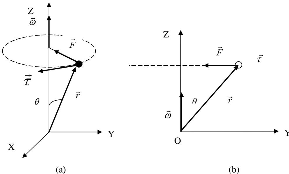
Figura 13.6. (a) La fuerza centrípeta  $\vec{F}$  produce una torca  $\vec{\tau} = \vec{r} \times \vec{F}$ . (b) La torca es perpendicular a los vectores  $\vec{r}$  y  $\vec{F}$  y dirigida hacia el lector.
