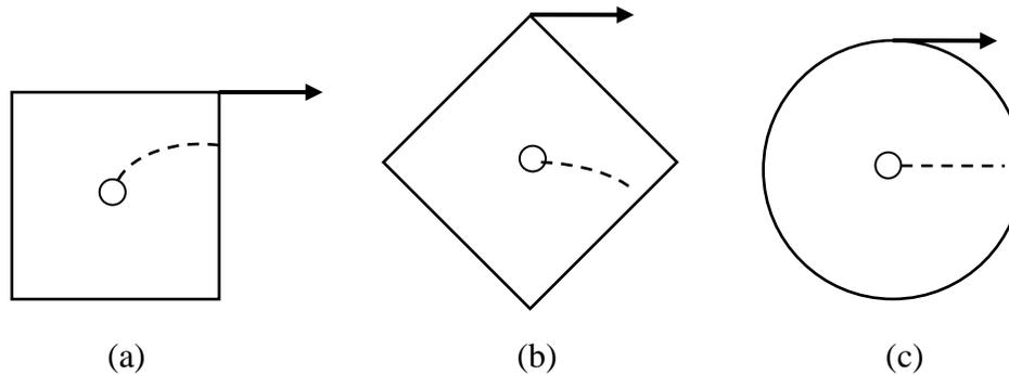
Figura 13.9. Ejemplos de equilibrio (a) estable, (b) inestable y (c) neutro.
