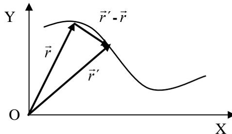
Figura 4.2. El vector  $\vec{r}$  señala la posición de la partícula en el tiempo  $t$ , el vector  $\vec{r}'$  señala la posición de la partícula en un tiempo posterior  $t'$ .
