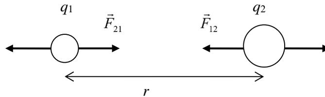
Figura 6.2. La fuerza entre dos cargas eléctricas puede ser atractiva o repulsiva.
