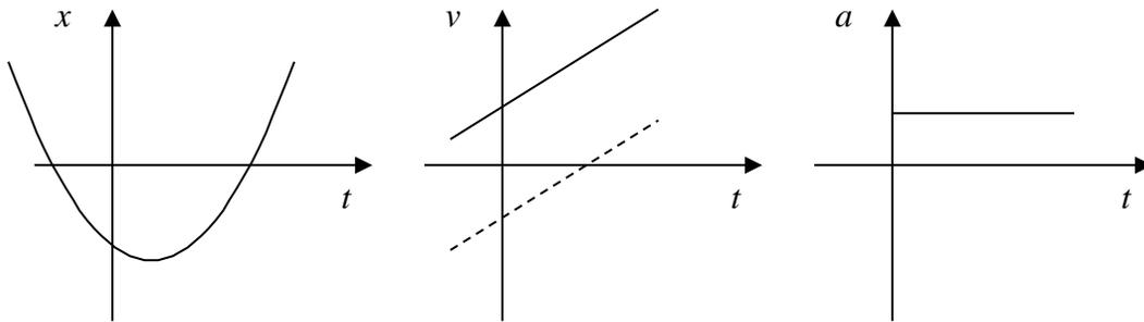
Figura 2.15a. Si la posición es una parábola ( $x=b+ct+dt^2$ ), sus ramas se abren hacia arriba cuando  $d$  es positiva.
