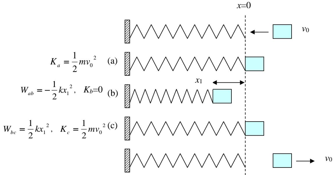
Figura 8.1. El bloque se mueve hacia el resorte, entra en contacto con él en  $x=0$  y lo comprime hasta  $x_1$ ; luego el resorte lo regresa.
