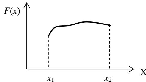
Figura 7.5. Para una fuerza  $F(x)$ , la integral representada en (10) es igual al área limitada por la curva, las líneas punteadas y el eje X.
