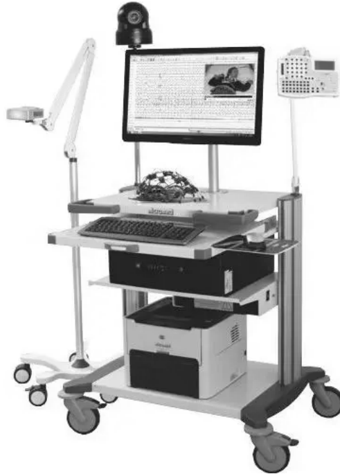
Figura 5.9 Electroencefalógrafo comercial. Se observan el teclado, el monitor, el panel de conexión de electrodos y otros accesorios. (Imagen tomada del folleto de BRAIN QUICK LTM).
