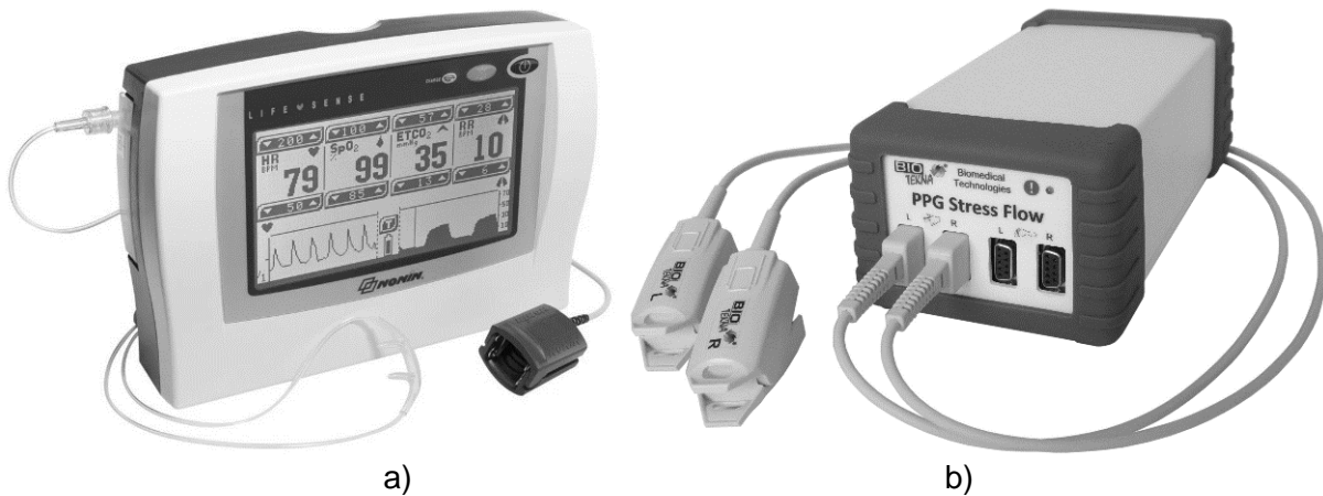
Figura 5.31 a) Capnógrafo y b) Fotopleletismógrafo. (Imágenes tomadas de los folletos de NONIN MEDICAL, INC. y BIOTEKNA BIOMEDICAL TECH., respectivamente).
