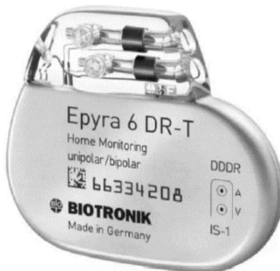
Figura 5.7 Marcapasos DDDR comercial que es compatible con Resonancia Magnética. (Imagen tomada del folleto de BIOTRONIK ADVANCE DEVELOPS).
