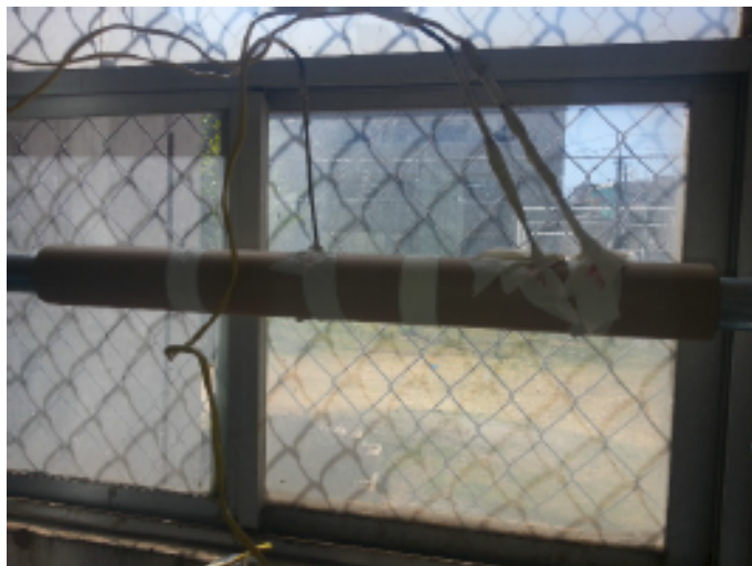
Figura 14.2: Porción de la tubería recubierta con aislante, mostrando las posiciones axiales de tres termopares, localizados en tres posiciones radiales distintas.
