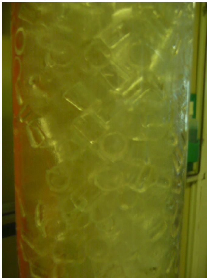
Figura 20.2: Anillos Rasching de vidrio de 10 x 10 mm, en las secciones empacadas de la columna.
