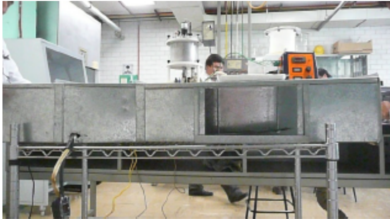
Figura 22.2: Cara lateral con puerta corrediza para colocar la muestra.
