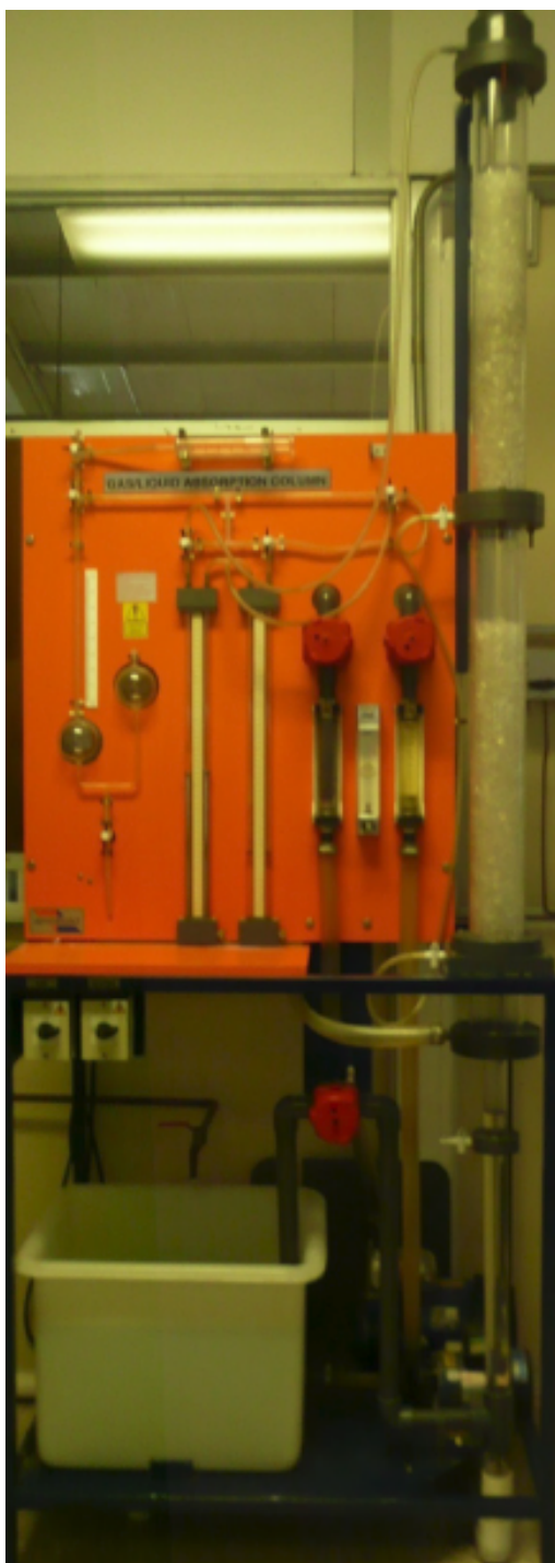
Figura 20.1: Torre de absorción con su tablero de instrumentación.
