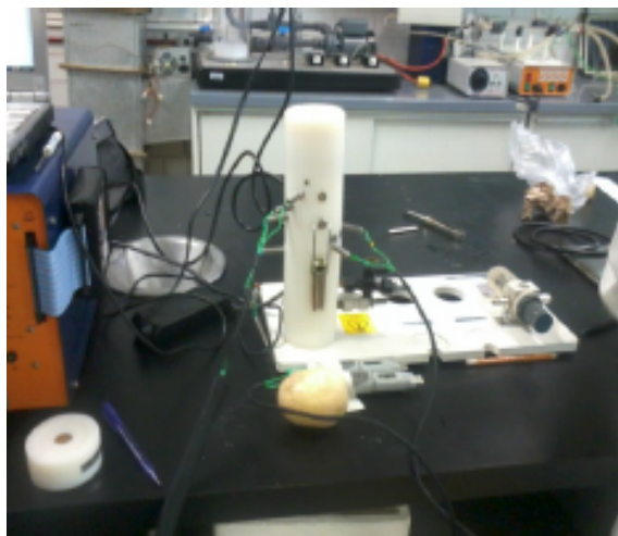
Figura 15.2: Elementos para la determinación del coeficiente de conductividad térmica del sólido.
