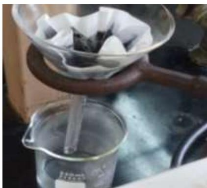
**Figura 3.4:** Filtrado de las muestras después del tratamiento con carbon activado
