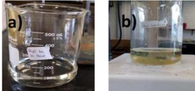
**Figura 5.1:** Muestras de agua a) de la llave y b) de Chapultepec. El sistema de Jarras incluye una serie de contenedores y propelas. En esta práctica se substituyó por un sistema de vasos de precipitados y agitación magnética.
