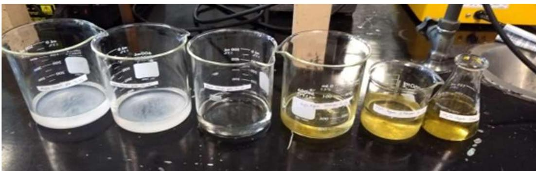
**Figura 5.4:** Formación de flóculos en las muestras de agua a analizar a pH óptimo.
