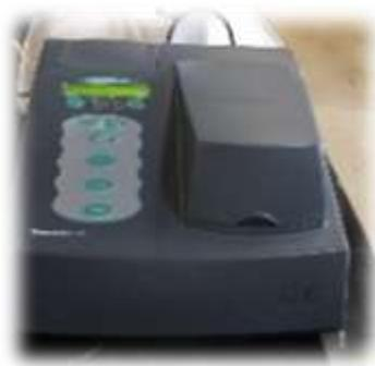
**Figura 2.1:** Fotografía del espectrofotómetro del laboratorio de Docencia
