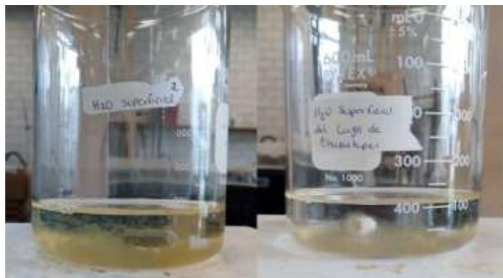
**Figura 5.2:** Agregación del coagulante y formación de flóculos. Flóculos formados en el agua clara del lago de Chapultepec.
