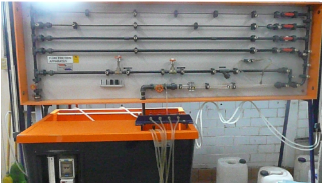
Figura 18.1: Banco de tuberías.
