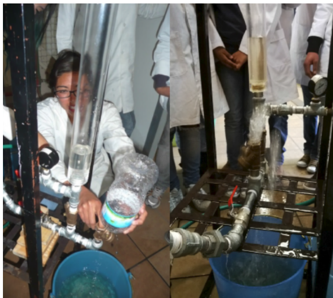
Figura 17.2: Operación de una bomba de ariete: (a) Inducción del flujo, abriendo manualmente la válvula de impulso I , situada aguas abajo. (b) Derrame de un pulso por la válvula de impulso I , situada aguas arriba.
