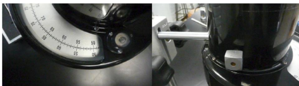
Figura 15.3: Detalles del cabezal del viscosímetro de Brookfield. (a) Nivel de burbuja y escala del torquímetro. (b) Dado selector de velocidad angular y clutch .
