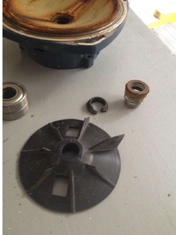
Figura 10.2: Impulsor de una bomba centrífuga con aspas rotas por el efecto de la cavitación.
