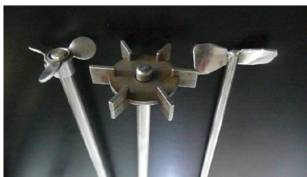
Figura 16.3: (a) Impulsor de propela marina. (b) Impulsor de turbina de Rushton. (c) Impulsor de paleta oblicua.
