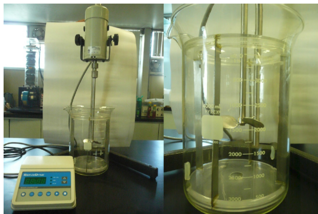
Figura 16.2: (a) Equipo de agitación instalado. (b) Vaso con desviadores de flujo.
