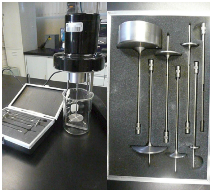
Figura 15.2: Viscosímetro de modelo VC y conjunto de agujas intercambiables.
