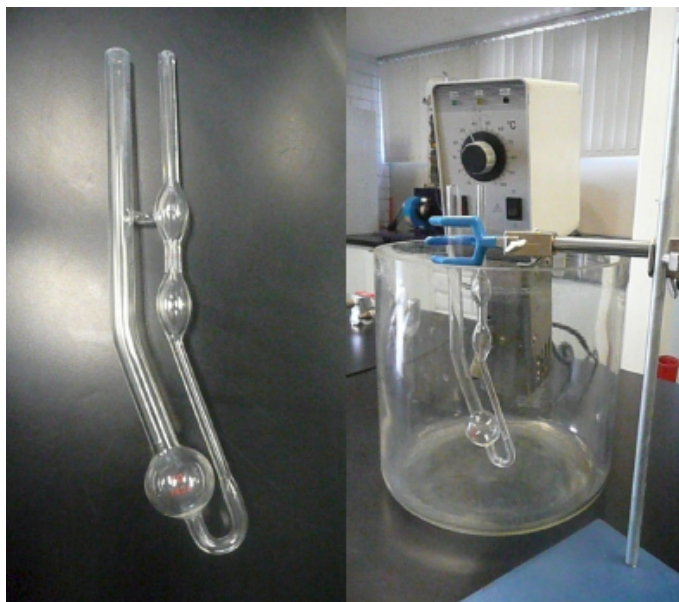
Figura 14.2: Viscosímetro de Cannon-Fenske y baño de temperatura controlada.
