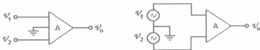
Figura 3.4. Representación esquemática del amplificador diferencial.
