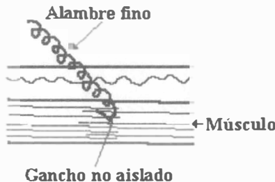
Figura 2.20. Electrodo intrategumento embobinado de alambre fino.
