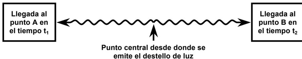
Figura 4.1 Definición de simultaneidad de acuerdo con Einstein. El destello de luz emitido desde el punto central llega en los tiempos  $t_1$  y  $t_2$  a los puntos A y B. Los tiempos  $t_1$  y  $t_2$  son simultáneos.
