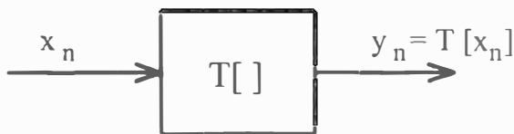
Figura 3.12 Un instrumento como sistema.
